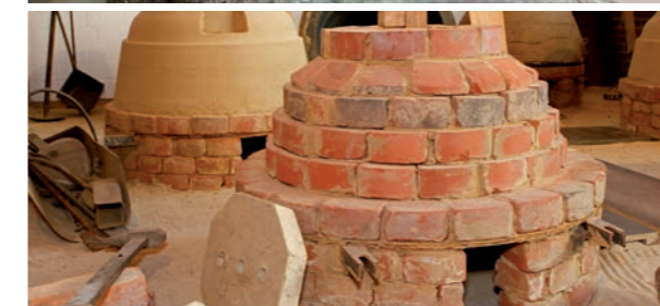
Klokkenvorm in de gietkuil
